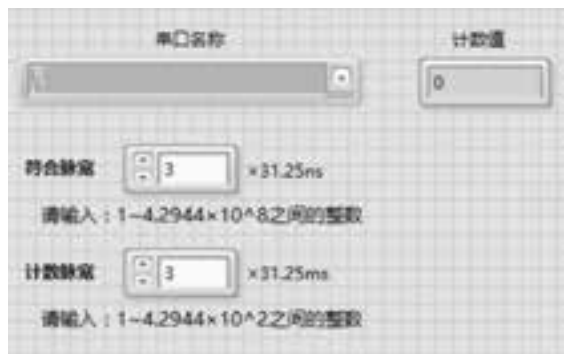
图 18: 单路单光子计数器数据采集VI前面板示意图。只需要输入串口名称, 符合脉宽和计数脉宽的值, 即可获得计数值。
