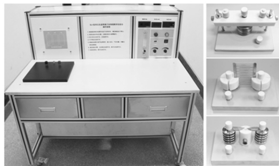
图 1 SJ-1 型常压低温等离子体实验平台及部分等离子体发生器组件照片
