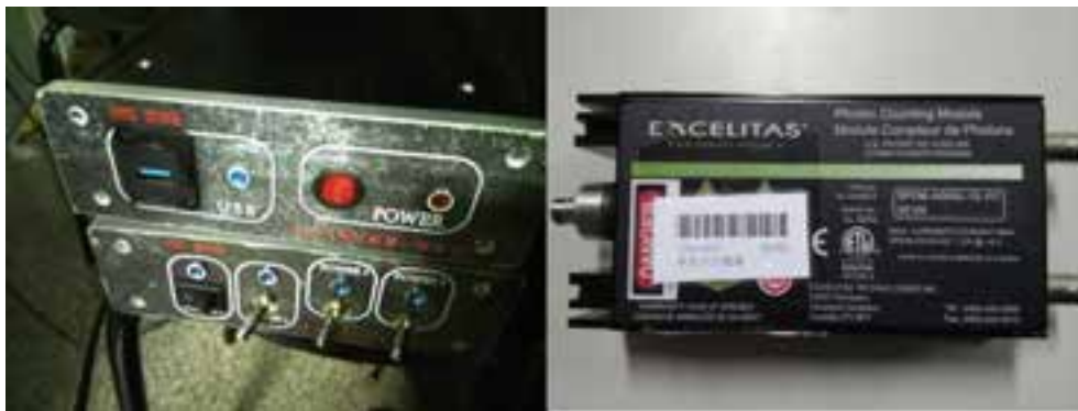
图 17: 左侧为符合计数系统, 可用于收集一个或多个单光子计数器的数据, 并判定信号间的量子关联。右侧为单光子计数器, 其探测光强的精密度可至一个光子。
