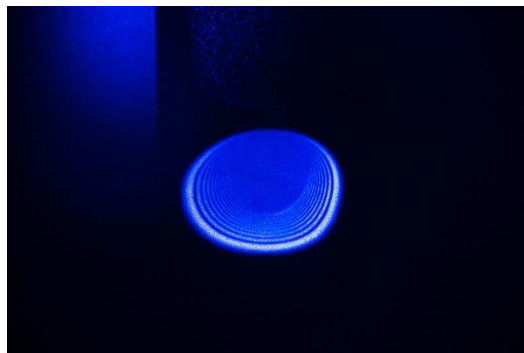
图 8 样品位于束腰后（发散）衍射图案
