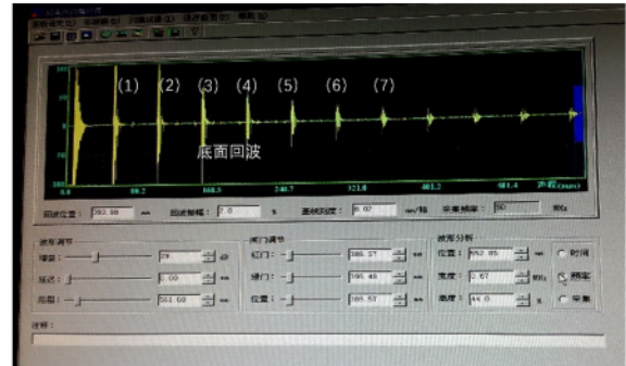
图 3 探头置于钢块 2 宽面显示的超声波形
