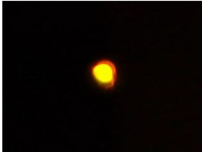
图 25: CCD上观察到的样本图像。绿色为样品对于532nm激光的反射，红色为样品发出的荧光。
