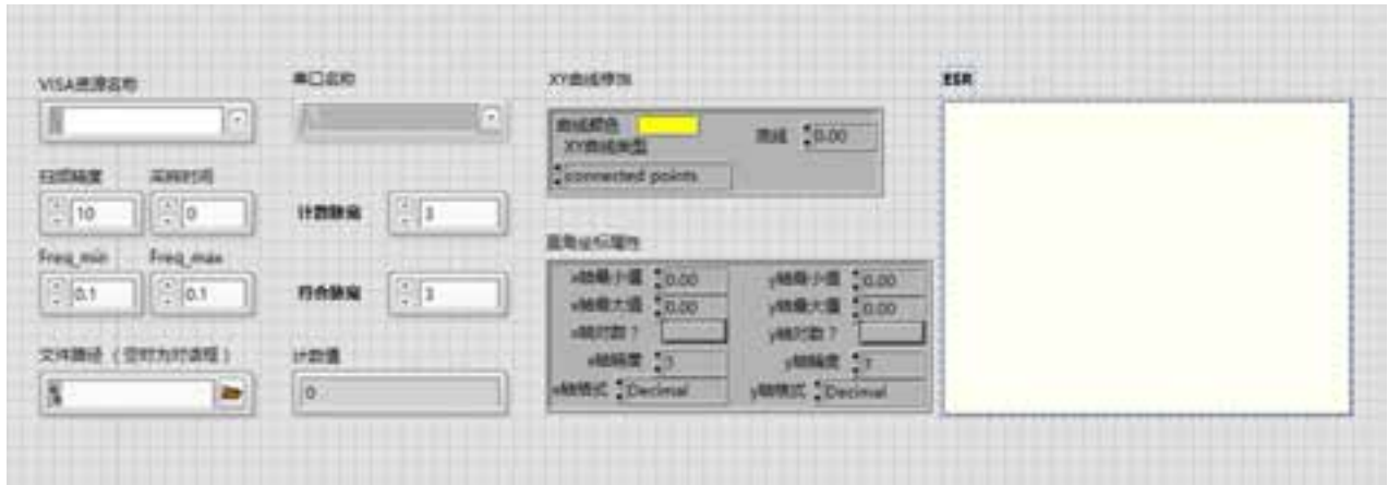
图 20: 荧光强度-微波频率图线绘制VI操作面板示意图，启动前先选择VISA和串口以及存图文件路径，之后调节扫频参数和计数参数（中间左侧六项）即可开始
